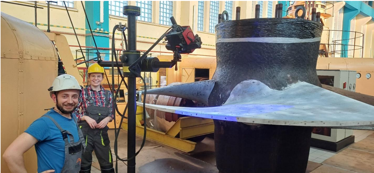
HPP Wały Śląskie Kaplan turbine 3d scan
